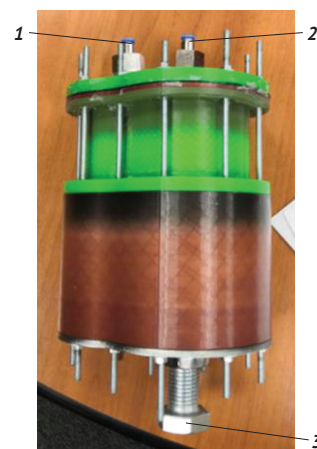
Рис. 4. Пневматический редуктор для питания двухтрубной тормозной системы грузового поезда 1 – быстросъемное соединение для питания тормозной магистрали; 2 – быстросъемное соединение для подвода питания; 3 – болт регулировочный
