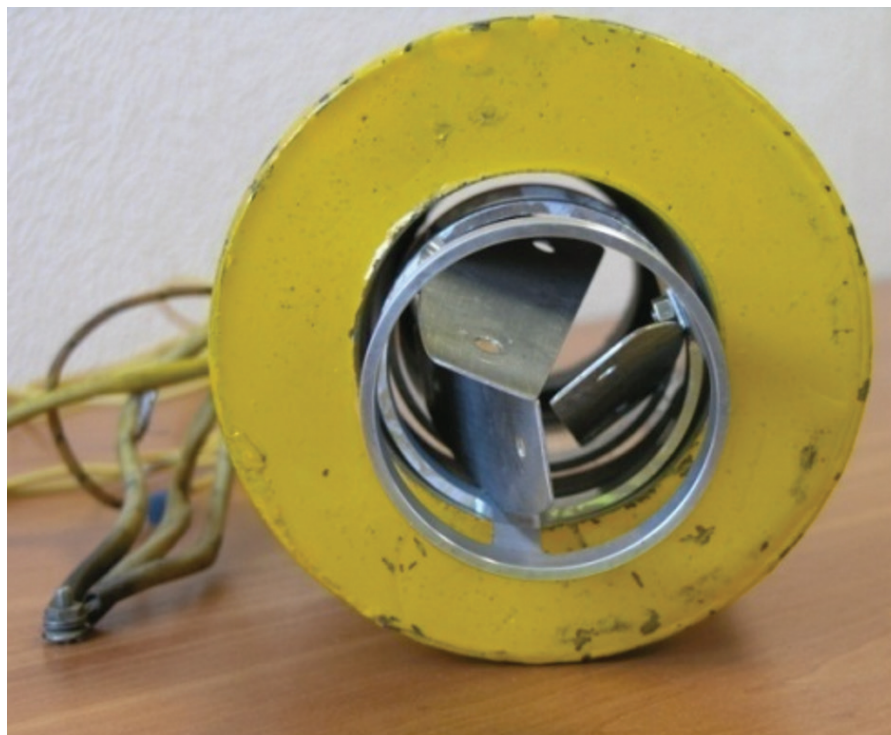
Рис. 11. Электрогенерирующий блок со снятыми торцевыми крышками
