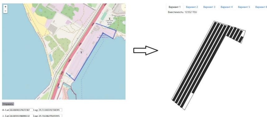
Рис. 6. Сгенерированный компьютером вариант конфигурации склада
