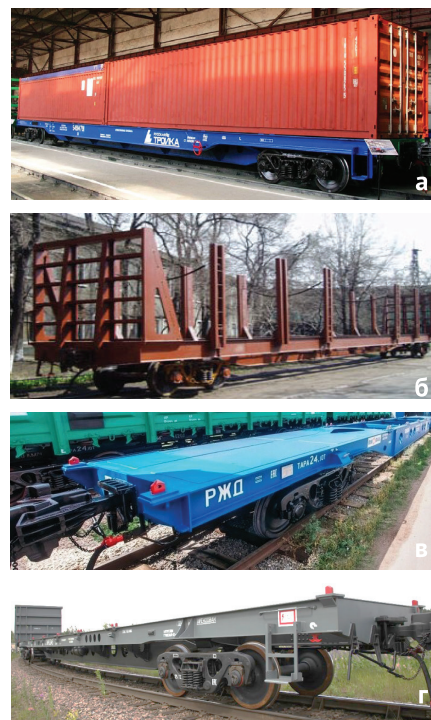
Рис. 1. Длиннобазные вагоны-платформы моделей: а) 13-1281 (база 19,7 м); б) 13-4108 (20 м); в) 13-6903 (19 м); г) 13-6726 (19 м)
