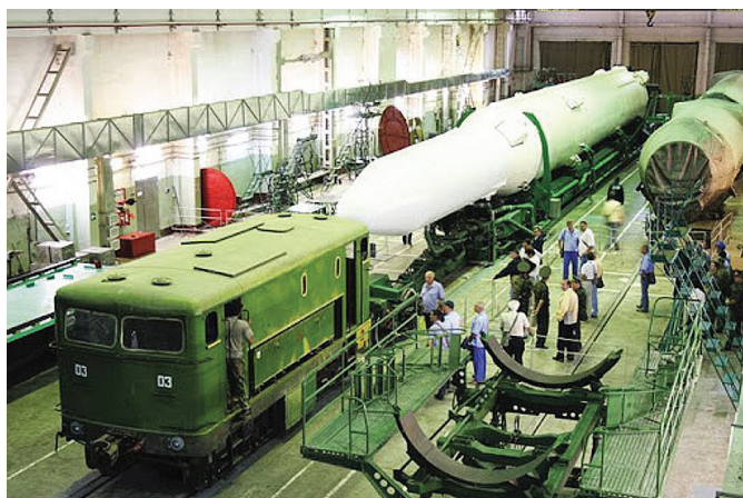
Рис. 7. Электровоз 11Т125 выпуска 1976 г. с кузовом единой конструкции для агрегатов 11Т125 и электровозов Т30 в монтажно-испытательном корпусе
