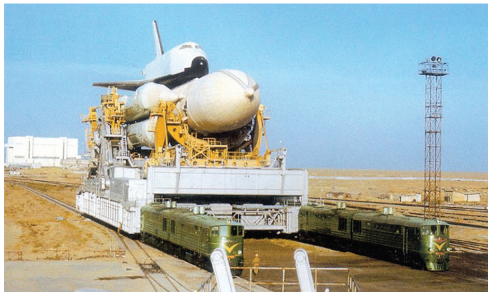
Рис. 4. Собранный габаритный макет РН «Энергия» — изделие 4М в процессе вывоза с тепловозами ПТЭЗ
