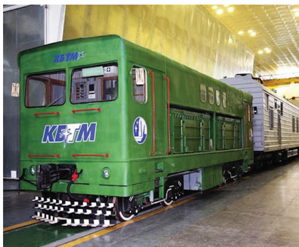
Рис. 8. Электровоз 11Т186 в монтажно-испытательном корпусе
