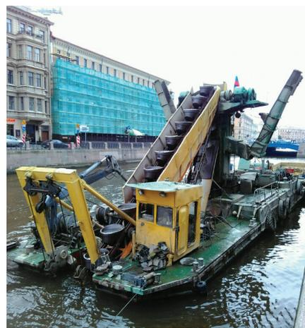
Рис. 8. Современный многоковшовый цепной плавучий экскаватор, построенный по схеме А. А. Бетанкура. Все та же бесконечная цепь с ковшами, приводимая в движение ДВС или электродвигателем. Очистка реки Мойки в Санкт-Петербурге (2020 г.)
