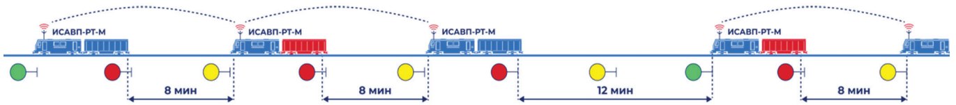
Рис. 2. Сравнение возможных межпоездных интервалов при разных средствах интервального регулирования движения поездов
