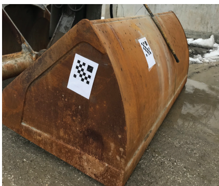
Рис. 2. Калибровочные шаблоны на грейфере мобильного крана Sennebogen
