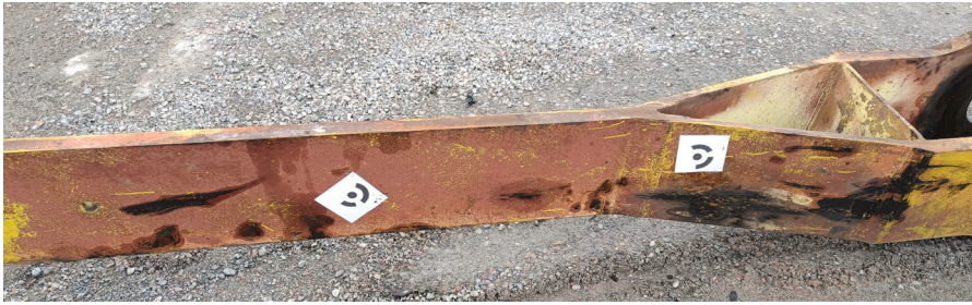
Рис. 1. Калибровочные метки на тяге противовеса портального крана «Альбатрос»
