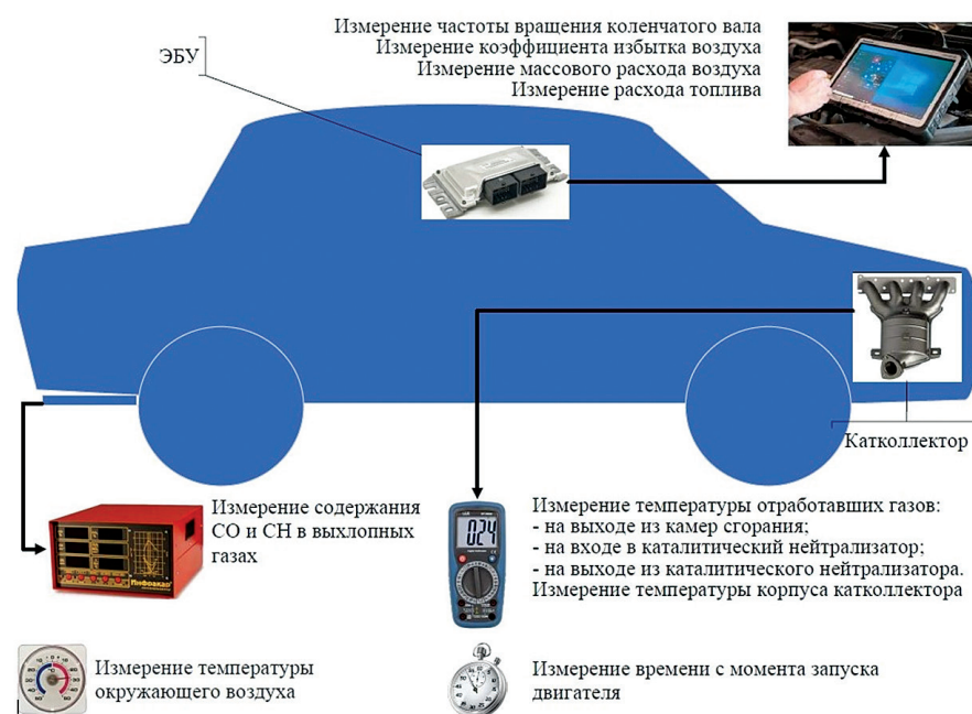
Общая схема подключенных приборов в экспериментальной установке
