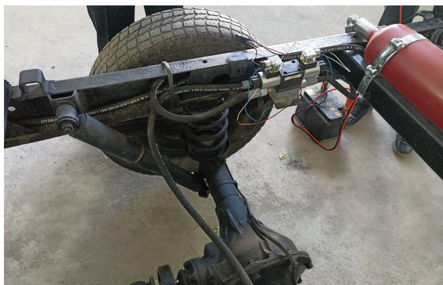
Рис. 4. Электромагнитный распределитель с переключателем
