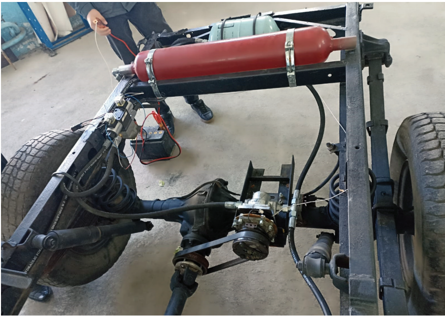
Рис. 2. Лабораторная установка вспомогательной системы для разгона автомобиля
