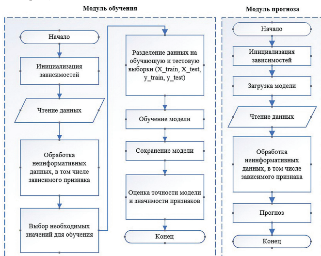
Рис. 1. Блок-схемы обучения и прогноза модели методом случайного леса
