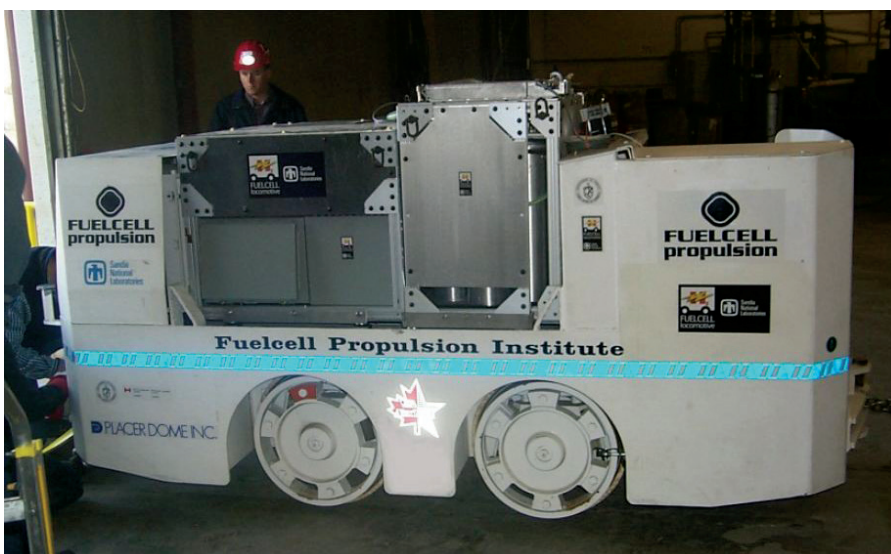
Рис. 1. Шахтный локомотив с силовой установкой на основе водородных топливных элементов
