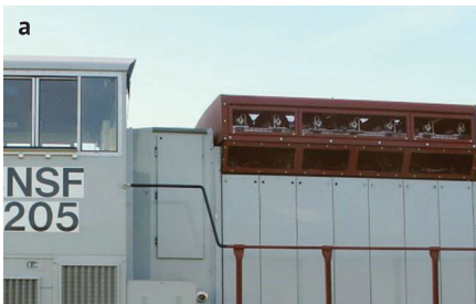
Рис. 6. Размещение водородных баков (а) и ТЭ (б)
