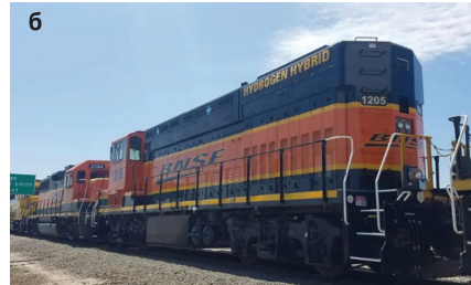
Рис. 5. Компонка водородно-аккумуляторного маневрового локомотива (а) и его внешний вид (б)
