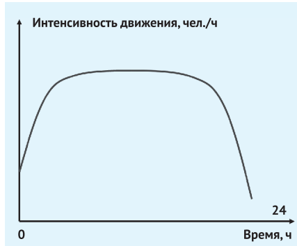
Рис. 1. Схематическое изображение характерного графика суточной неравномерности интенсивности транспортных потоков без пиковых периодов
