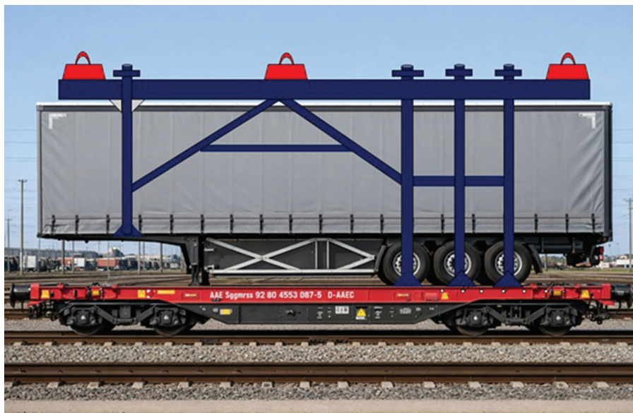
Рис. 5. Разработанный механизм (спредер) для обеспечения автоматизированной погрузки и выгрузки полуприцепов на железнодорожные платформы
