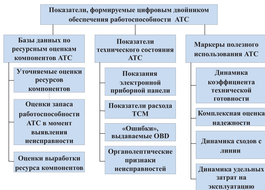
Рис. 3. Предлагаемая система показателей, формируемых цифровым двойником обеспечения работоспособности автотранспортных средств. ТСМ – топливо-смазочные материалы.
