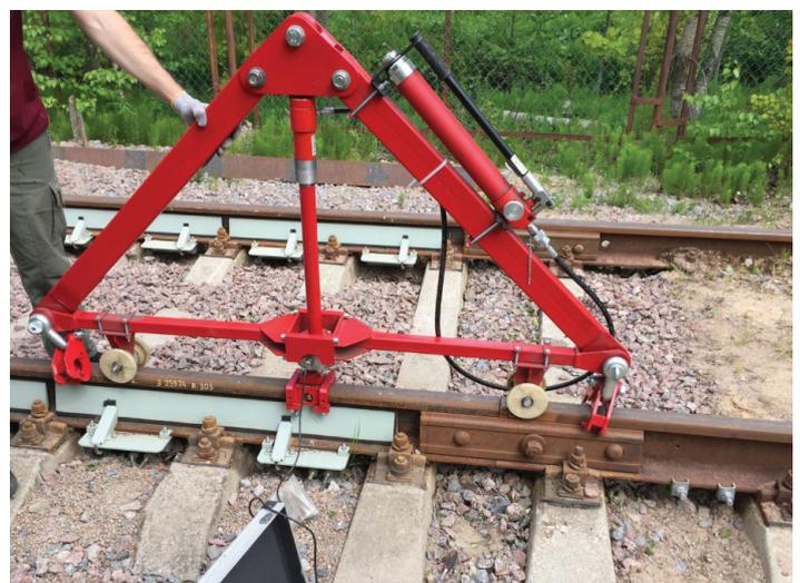
Рис. 11. Общий вид устройства для приложения эталонных нагрузок в ходе проведения работ по определению масштабов измерения
