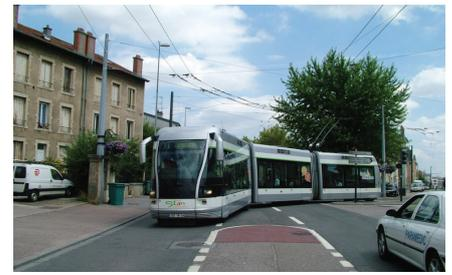
Рис. 3. Нанси (Франция) – Avenue du General Leclerc / Avenue Foch. Bombardier GLT/TVR (шинный трамвай, работающий в режиме стандартного троллейбуса (30.06.2008 г.))
