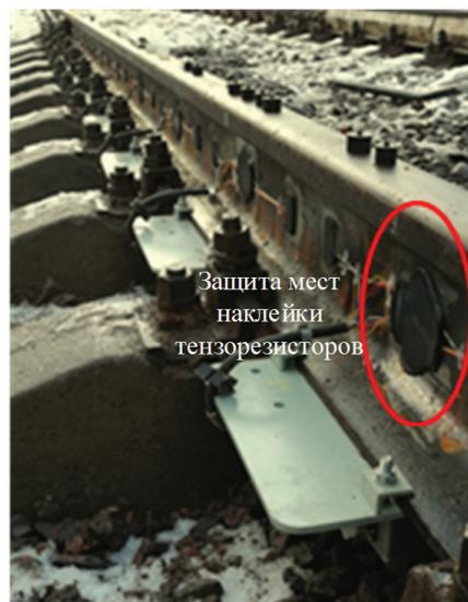
Рис. 6. Фото фрагмента измерительного рельса
