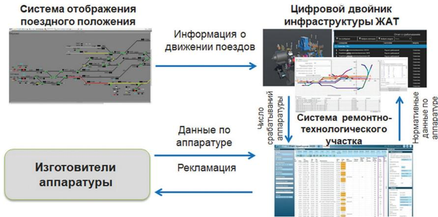
Рис. 1. Технология управления жизненным циклом аппаратуры
