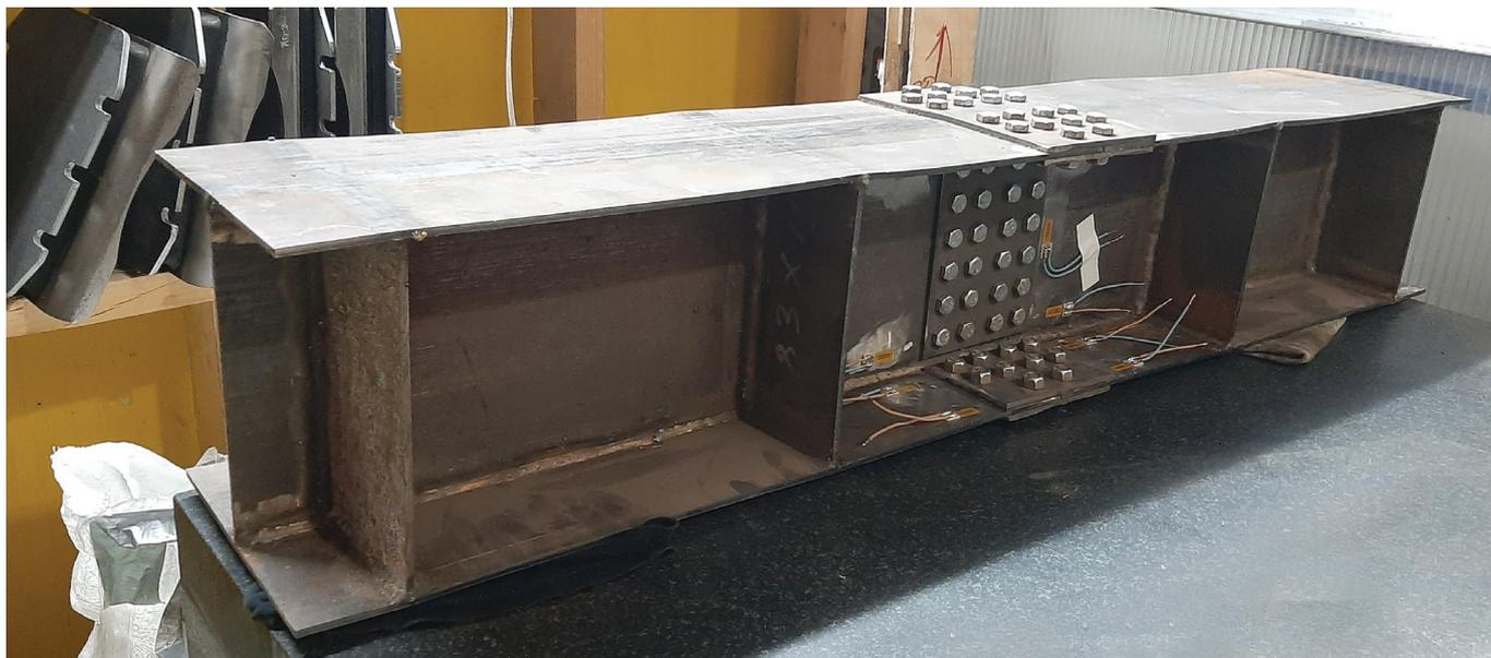
Рис. 2. Модельный образец балки из стали 30ХГСА с болтовым соединением
