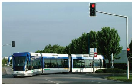
Рис. 5. Кан (Франция) – Boulevard Henri Becquerel / Rue Leon Foucault Bombardier GLT/TVR (вагон GLT следует на дизельной тяге выезжает из депо и направляется на маршрут, пантограф на средней секции опущен (10.05.2009 г.)
