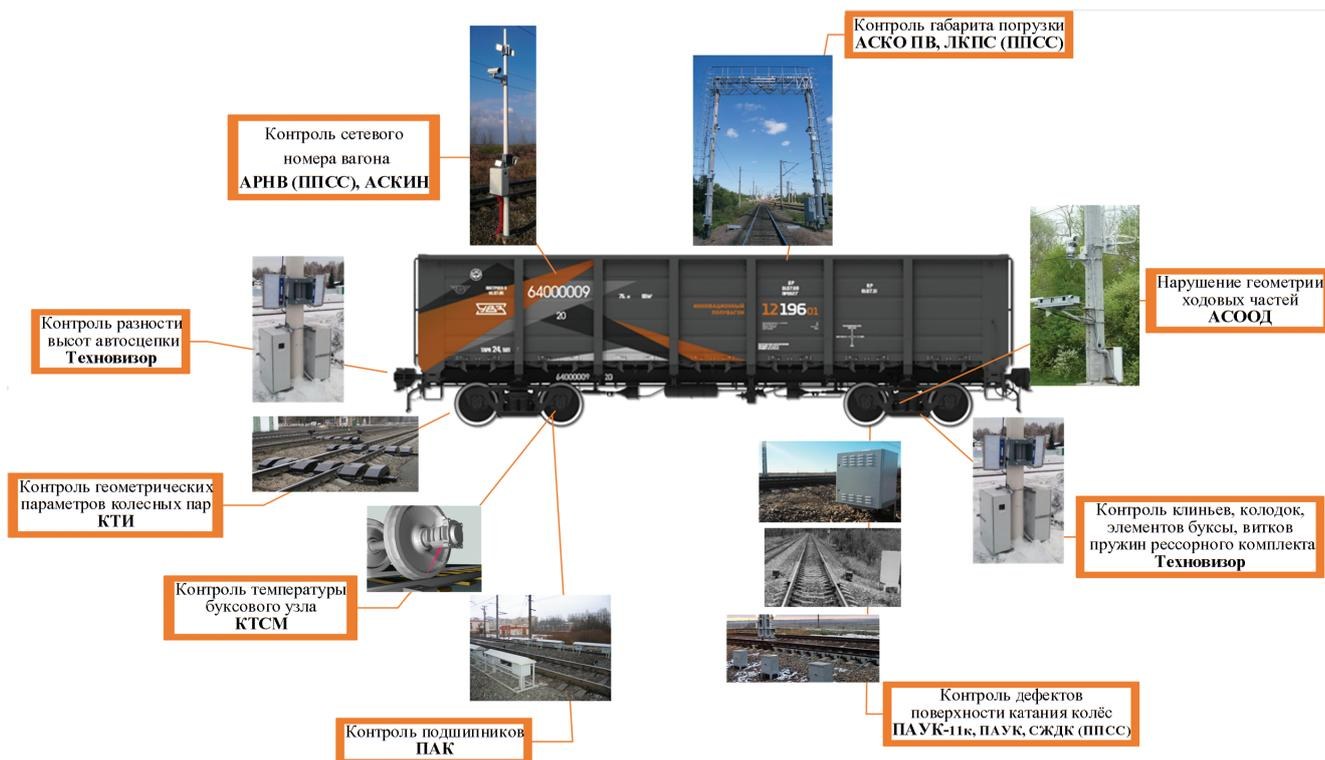
Рис. 2. Обзор систем контроля, применяемых в России
