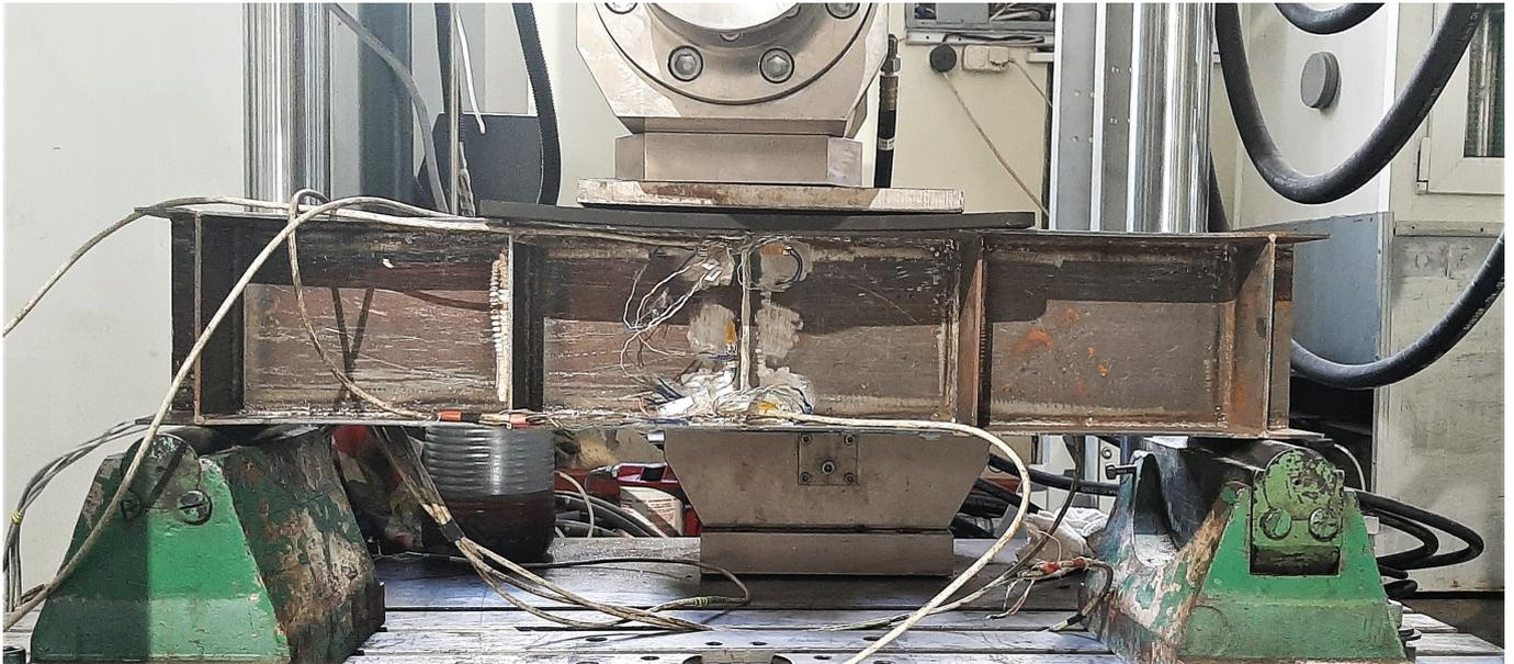
Рис. 1. Модельный образец балки из стали 30ХГСА с поперечным сварным швом
