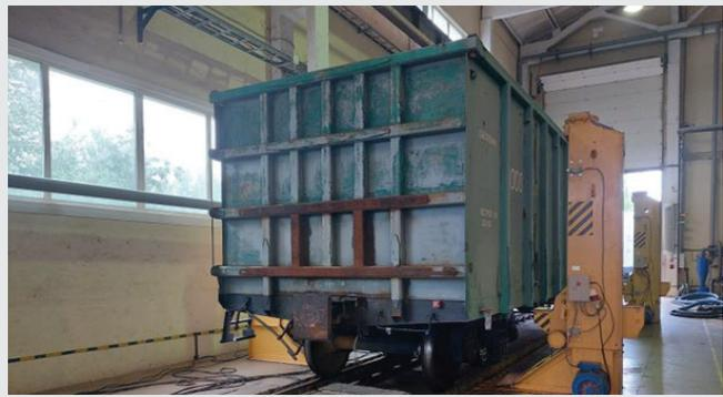
Силоизмерительный блок представлен в виде четырех тензOMETрических датчиков силы и, как следствие измеряемый ударный импульс является расчетным (сигнал суммируется по показаниям четырех датчиков), а также содержит информацию не только о входном сигнале, но и о комплексном коэффициенте передачи УПЭ, что вносит дополнительную погрешность в определяемую величину силы
