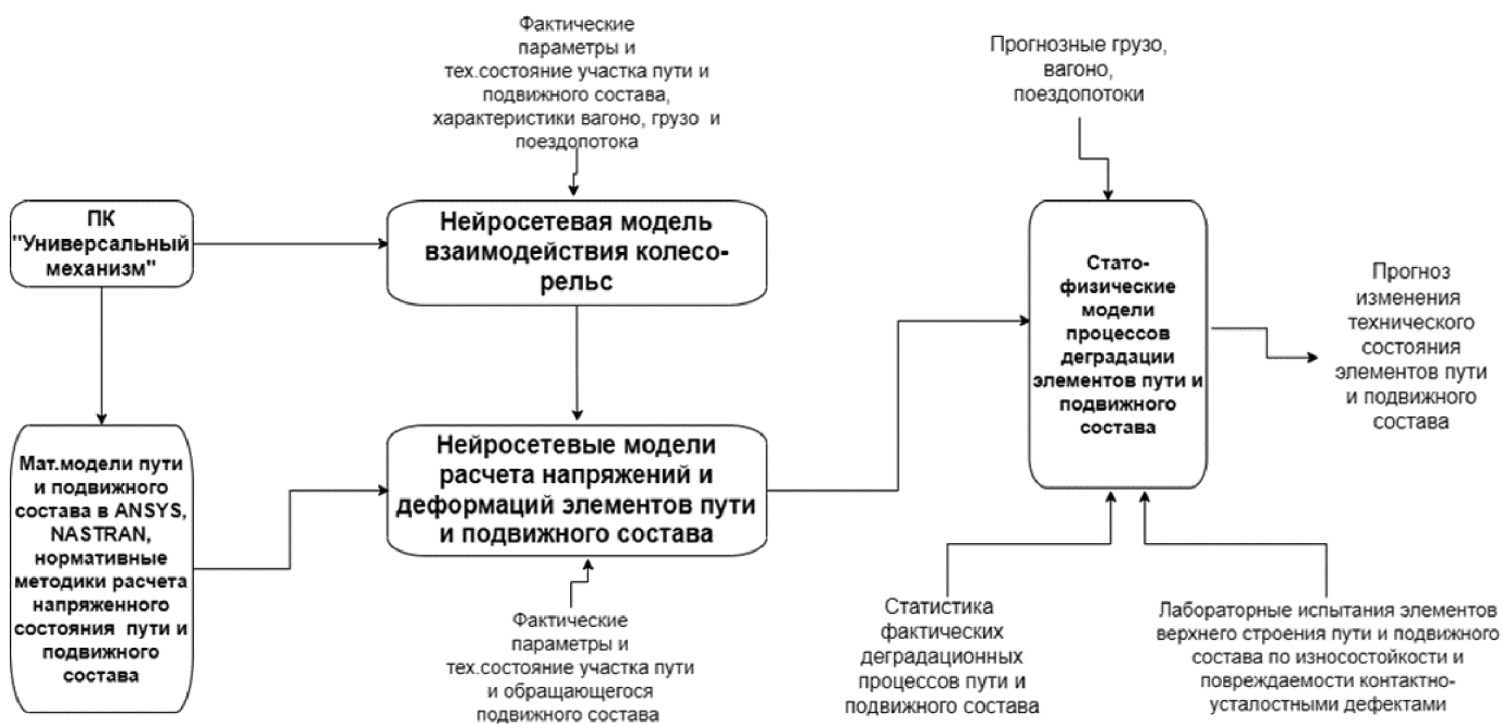
Рис. 9. Схема исследований для построения моделей взаимодействия пути и подвижного состава и прогнозных моделей расчета деградации их узлов и элементов
