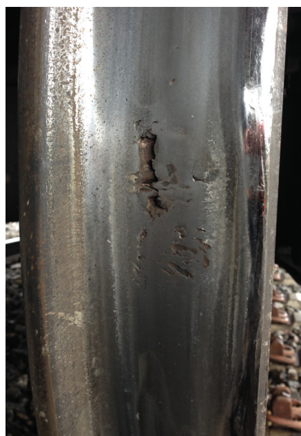
Рис. 1. Выщербина на поверхности катания колеса
