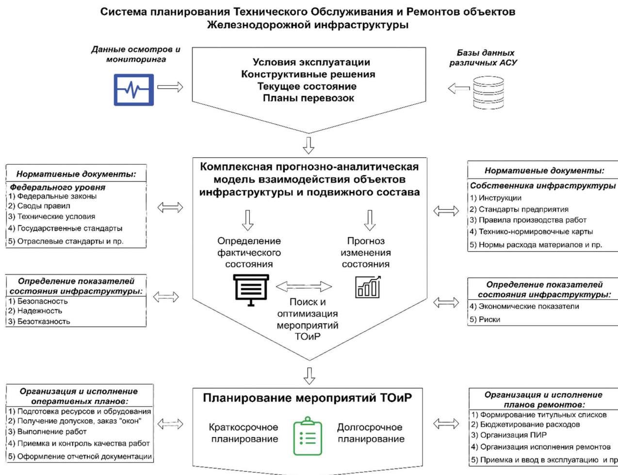
Рис. 1. Схема системы планирования технического обслуживания и ремонтов объектов железнодорожной инфраструктуры с применением прогнозного моделирования
