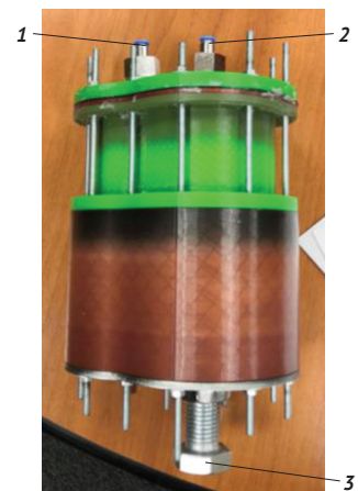
Рис. 4. Пневматический редуктор для питания двухтрубной тормозной системы грузового поезда 1 – быстросъемное соединение для питания тормозной магистрали; 2 – быстросъемное соединение для подвода питания; 3 – болт регулировочный
