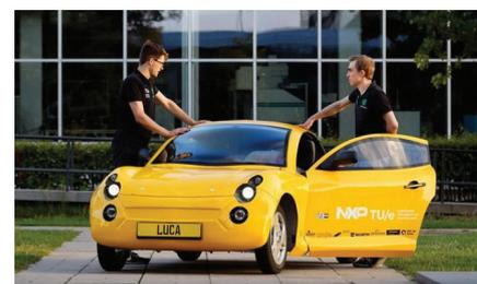
Рис. 9. Автомобиль из переработанного мусора «Лука»
