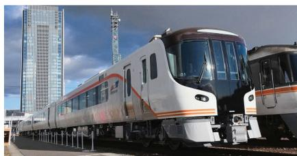
Рис. 12. Поезд с гибридной силовой установкой серии HC85
