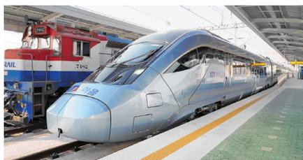
Рис. 11. Скоростной электропоезд с распределенной тягой KTX-Eum
