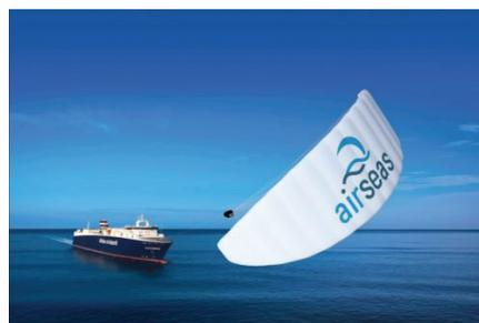
Рис. 16. Парус Seawing на грузовом судне Ville de Bordeaux
