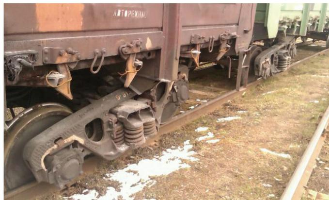
Рис. 2. Случаи проваливания колеса колесной пары внутрь колеи
