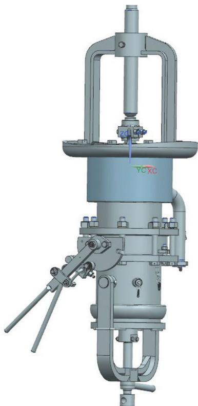
Рис. 2. Устройство нижнего слива с дисковым затвором Ду-200
