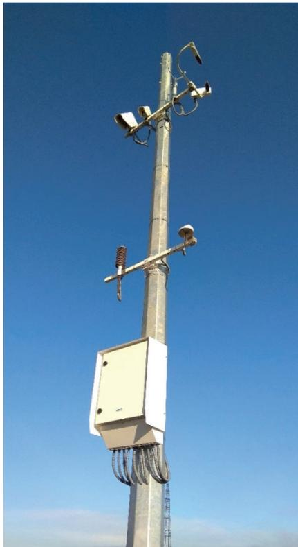
Рис. 5. Смонтированная метеостанция на объекте мониторинга
