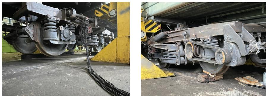
Рис. 9. Имитация схода с провалом первого по ходу движения колеса
