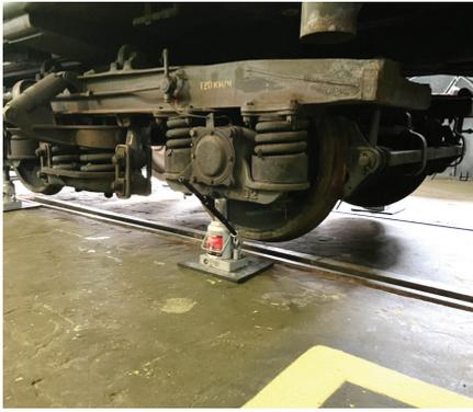
Рис. 11. Имитация последовательного схода всех колес с рельсов
