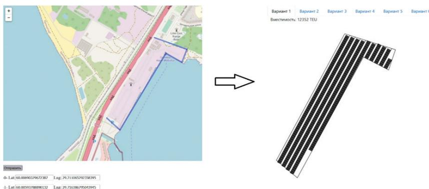
Рис. 6. Сгенерированный компьютером вариант конфигурации склада
