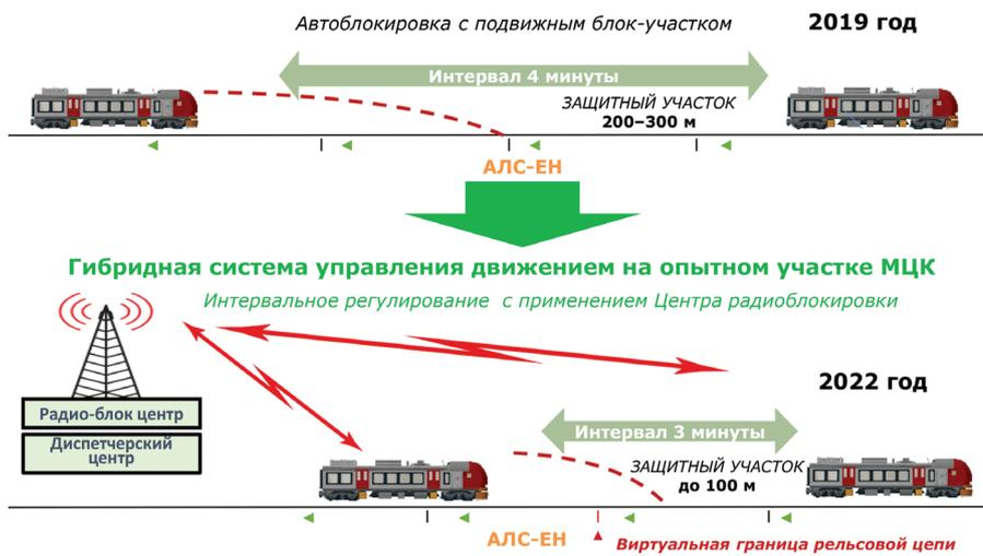
Рис. 7. Переход на гибридную систему управления движением на опытном участке МЦК
