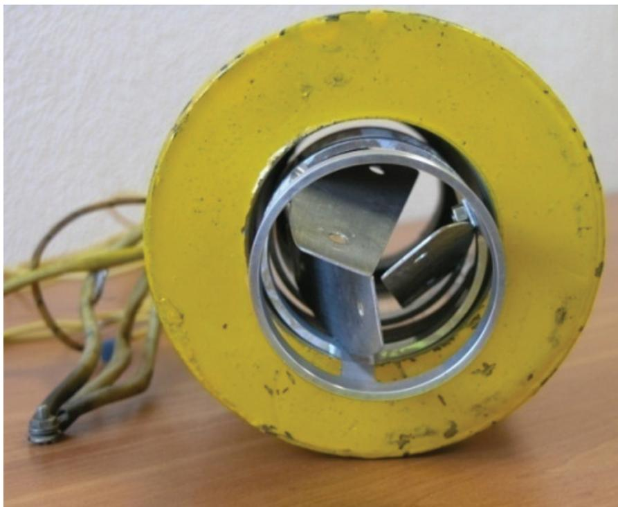
Рис. 11. Электрогенерирующий блок со снятыми торцевыми крышками
