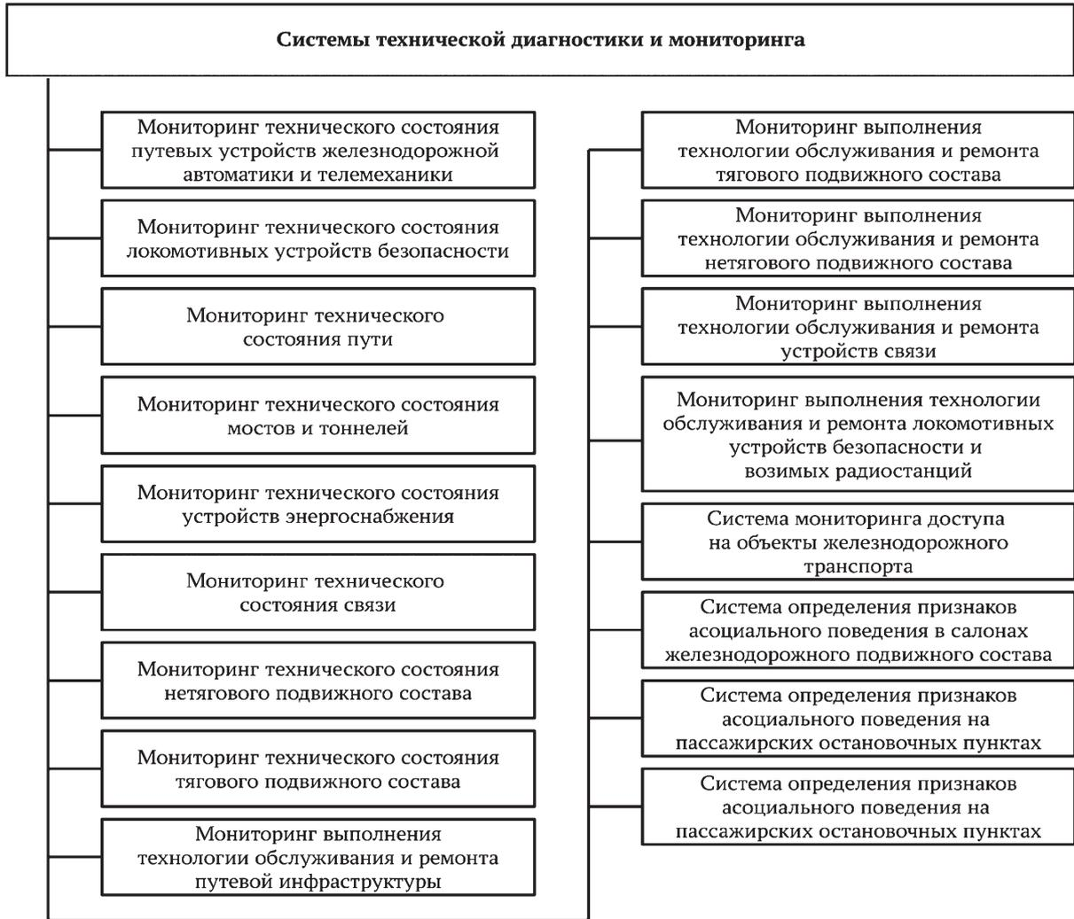
Рис. 4. СТДМ, эксплуатируемые и планируемые к применению на железнодорожном транспорте
