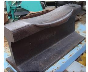
Рис. 2. Зона пластического течения в головке рельса
