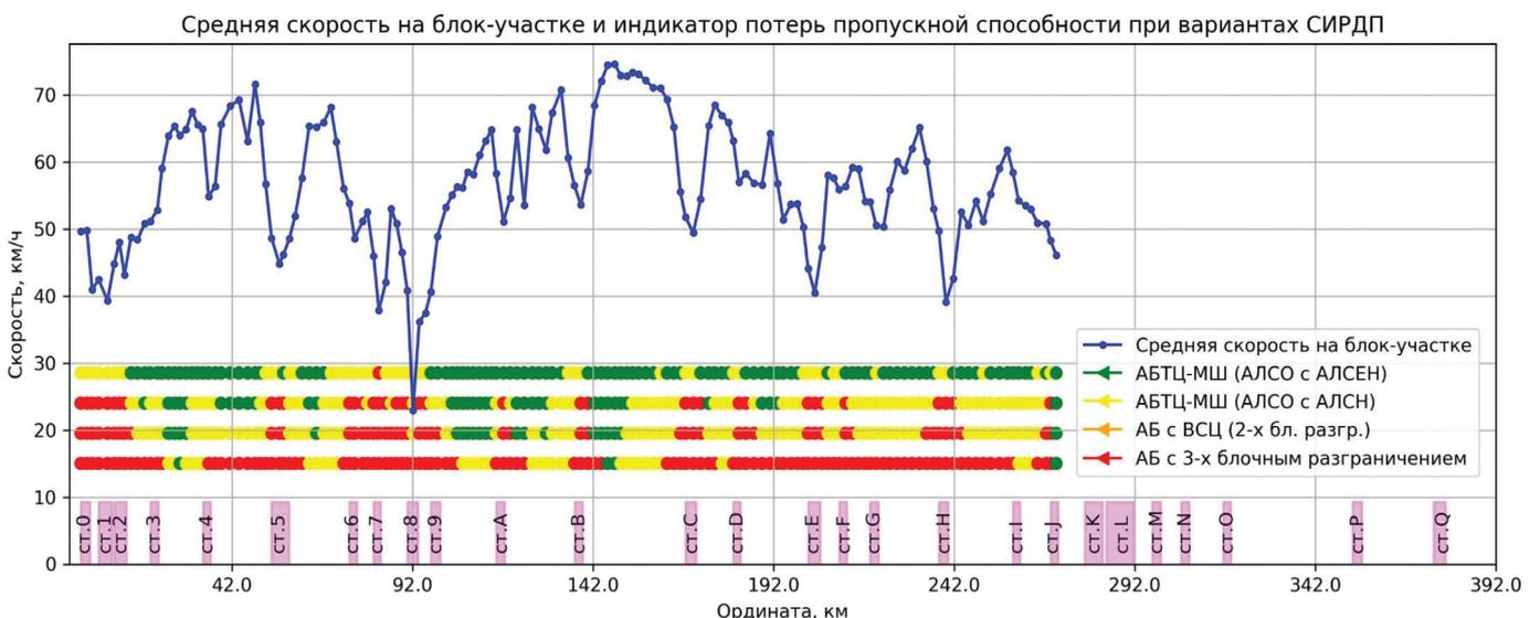
Рис. 5. Индикатор вероятности потерь пропускной способности участка железной дороги
