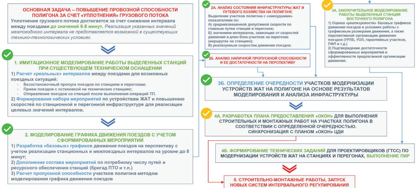
Рис. 2. Алгоритм мероприятий по модернизации устройств ЖАТ на Восточном полигоне
