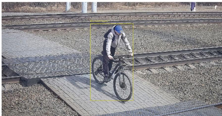
Процесс распознавания и определения отвлекающего фактора: а) использование телефона; б) надетый капюшон; в) надетые наушники при групповом прохождении; г) пересечение путей на велосипеде
