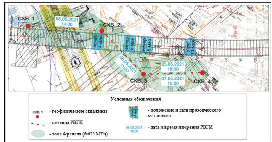
Рис. 4. Схема измерений по технологии радиоволновой геоинтроскопии межскважинного пространства (f = 625 кГц)
