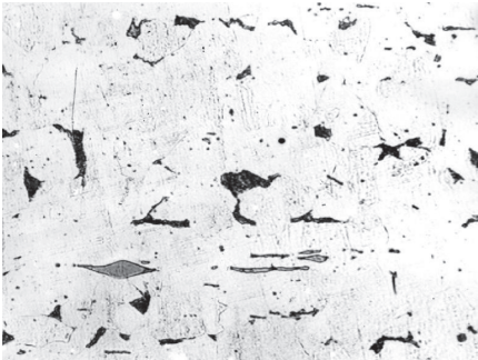
Рис. 4. Микрошлиф травленого металла винта (белое поле – феррит, темные зерна – перлит)
