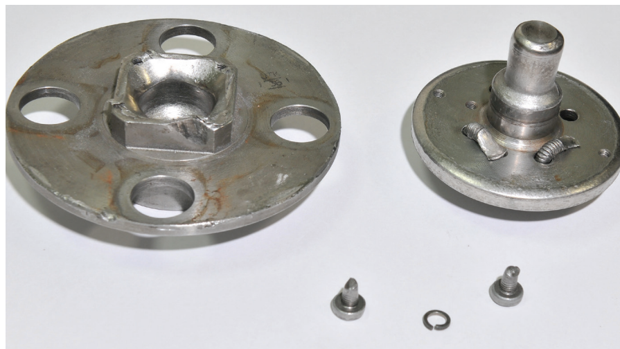
Рис. 1. Внешний вид фрагментов разрушенной противоюзной системы (случай 1)
