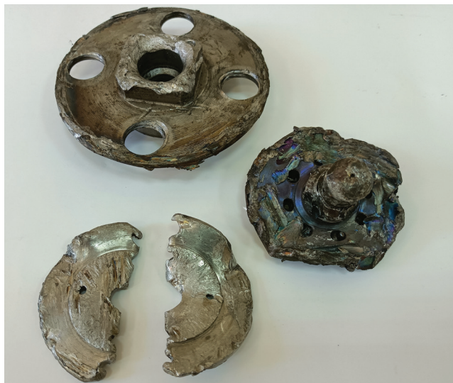
Рис. 2. Внешний вид фрагментов разрушенной противоюзной системы (случай 2)
