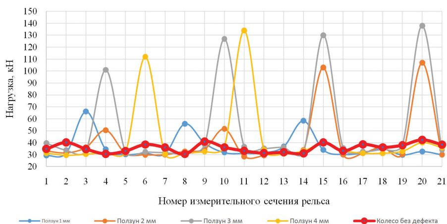
Рис. 7. Максимальная вертикальная сила, зарегистрированная в каждом измерительном сечении при движении порожнего вагона-цистерны на скорости 10 км/ч
