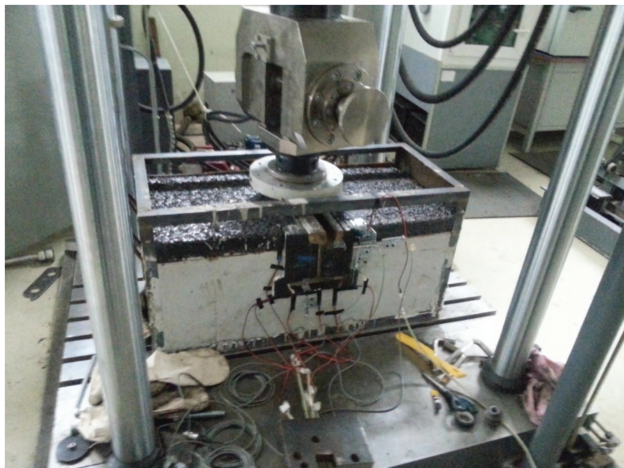
Рис. 1. Модель конструкции трамвайного пути с вкладышами
