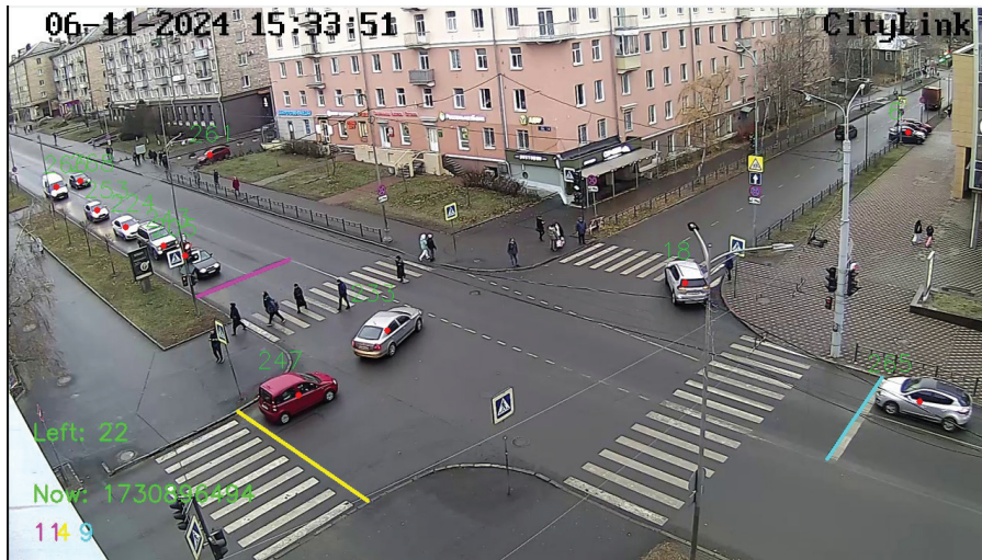
Рис. 7. Кадр публичной видеокамеры пересечения проезжих частей ул. Ленина и ул. Андропова г. Петрозаводска, на котором выполняется алгоритм распознавания движущихся объектов
