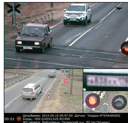
Рис. 2. Видеоконтроль на переезде
