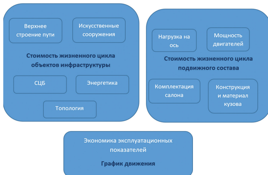
Структурная схема взаимосвязи технических параметров ВСМ и экономических критериев
