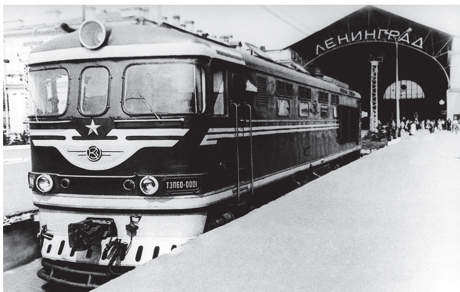
Рис. 6. Первый скоростной тепловоз ТЭП60-001. 1961 [10]
