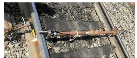
Рис. 2. Общий вид устройства для тарировки измерительных трактов при регистрации боковых сил
