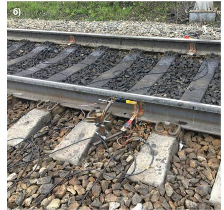
Рис. 1. Общий вид измерительного участка и его элементов: а) схема расстановки измерительного оборудования по участку:  $V_n, G_n$  – вертикальные / боковые силы на наружном рельсе,  $V_v, G_v$  – вертикальные / боковые силы на внутреннем рельсе,  $RV_n, RV_v$  – вертикальный прогиб наружного / внутреннего рельса,  $RG_n, RG_v$  – боковое отжатие головки наружного / внутреннего рельса; б) общий вид установки датчиков во 2-м испытательном сечении
