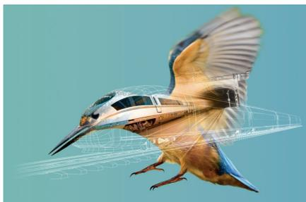
Рис. 3. Обвод головы зимородка и форма оконечности поезда Синкансэн
