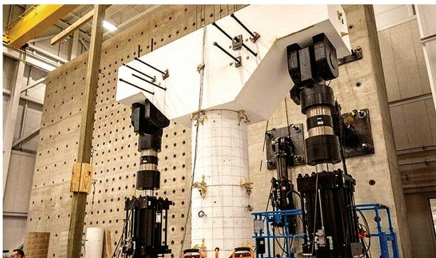
Рис. 1. Новая конструкция мостовых опор – гибридный скользящий-качающийся мост
