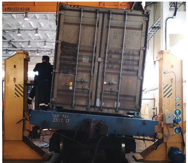
Рис. 16. Испытания контейнера: схема приложения испытательной нагрузки (слева); натурные испытания (справа)
