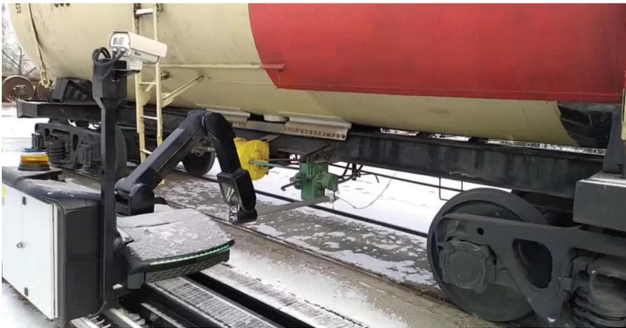
Рис. 2. Робототехнический комплекс при выполнении операций
