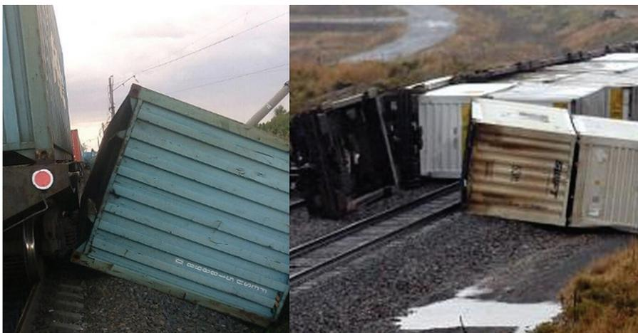
Рис. 1. Результаты воздействия бокового ветра: падение контейнера (Россия, Амурская область, 2016 г.) (слева); сход подвижного состава (США, 2019 г.) (справа)
