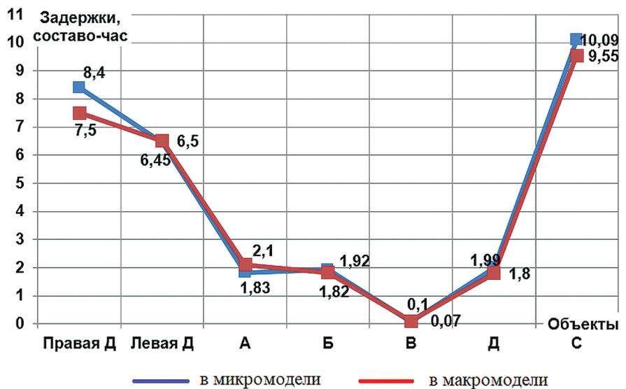
Рис. 4. Расчет задержек в горловинах на подробных и укрупненных моделях
