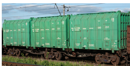
Рис. 1. Платформа сочлененного типа модели 10-630-01 со съемным кузовом для перевозки минеральных удобрений
