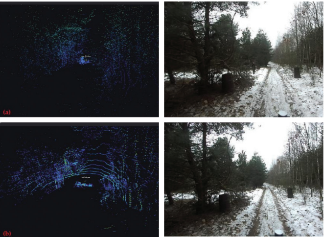
Рис. 8. Сравнение 3D-карт облаков точек, сгенерированных с помощью лидаров Ouster OS0-32 (a) и Velodyne VLP-16 (b)
