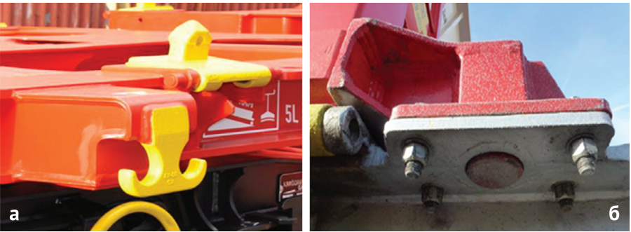
Рис. 4. Элементы крепления съемных кузовов на железнодорожной платформе компании Innofreight: а) фитинговый упор; б) ограничивающее устройство stop block
