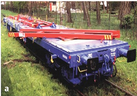
Рис. 6. Дополнительная рама для установки контейнера и запирающее устройство компании RailMotion: а) удерживающая рама; б) устройство, запирающее раму
