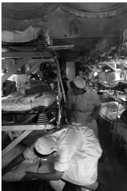
Рис. 4. Оборудование санитарных вагонов первой половины XX в. станками с коническими винтовыми пружинами
