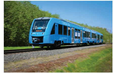
Рис. 6. Электропоезд на водородных топливных элементах Coradia iLint (Alstom, Франция)
