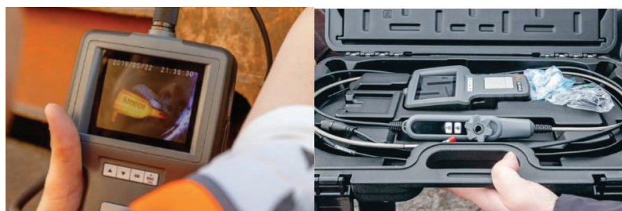
Рис. 9. Видеоэндоскоп компании «Модуль» для контроля состояния фитинговых упоров
