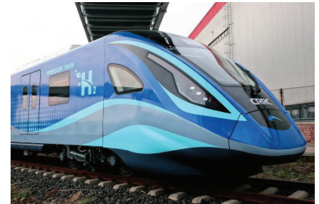
Рис. 7. Поезд на водородном двигателе производства компаний CRRC и Chengdu Rail Transit (Китай)
