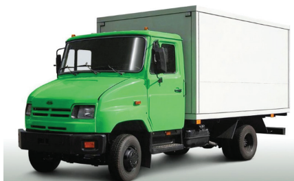
Категория N2 Автомобиль ЗИЛ-5301 («Бычок»), фактическая полная масса около 7 т, грузоподъемность до 3,5 т
