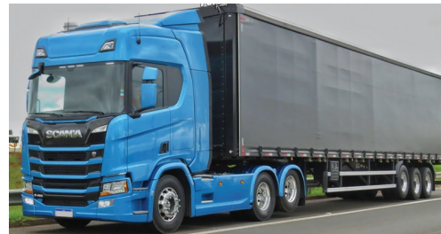
Категория N3 Автопоезд в составе седельного тягача Scania и полуприцепа с тентовым кузовом, фактическая полная масса автопоезда до 40 т, грузоподъемность до 30 т
