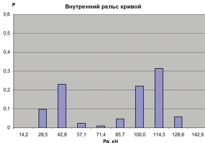
Рис. 1. Гистограмма распределения вертикальных сил, действующих на рельсы от проходящих вагонов
