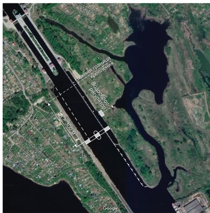
Рис. 9. Схема создания переходного уравнительного бассейна в нижнем подходе канале Городецких шлюзов.
