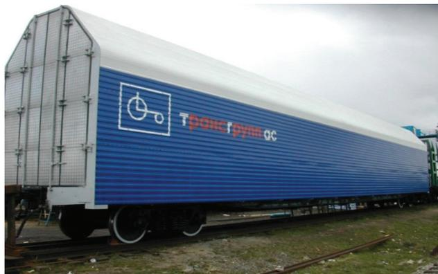
Рис. 4 Крытый вагон для перевозки 12 автомобилей в два яруса модели 23-469-08
