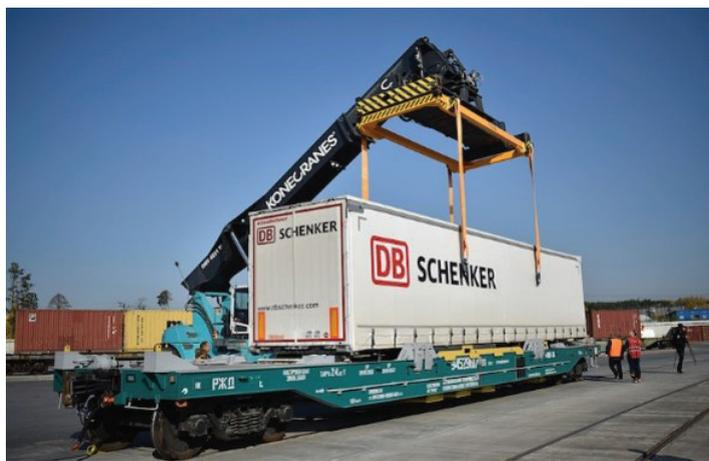
Рис. 3. Погрузка контейнера на вагон-платформу модели 13–6987 с помощью съемной корзины и ричстакера
