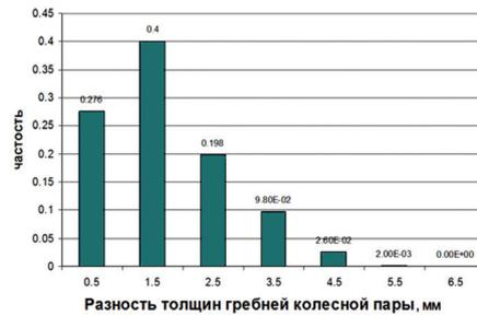
Рис. 4. Плотность распределения разности толщины гребней колес в колесной паре
