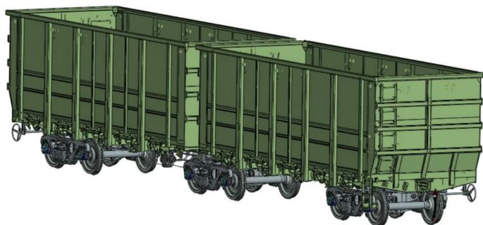
Рис. 1. Цифровая модель полувагона 12–6877–02, созданная в среде SolidWorks
