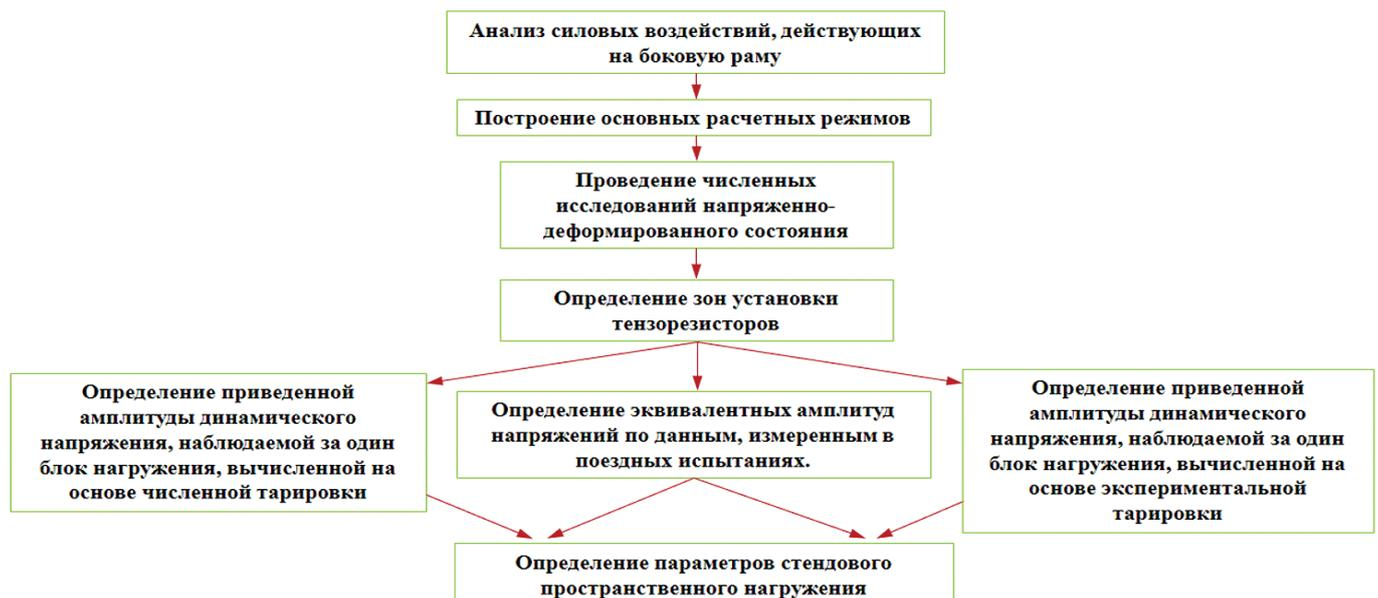
Рис. 1. Алгоритм определения параметров стендового пространственного нагружения элементов тележек
