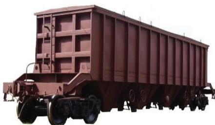
Рис. 6. Вагон-хopper модели 12-9765 для перевозки глинозема, алюминиевой продукции и тарноштучных грузов
