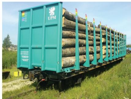
Рис. 1. Вагон-платформа модели 13-926-01 с оборудованием для перевозки леса из высокопрочной стали: грузоподъемность — 66 т; тара — 27,8 т; полезный объем — 160 м<sup>3</sup>
