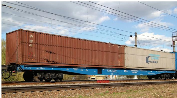
Рис. 5. Первый вагон-платформа модели 23-469-07 для перевозки двух контейнеров длиной 40' или четырех 20'
