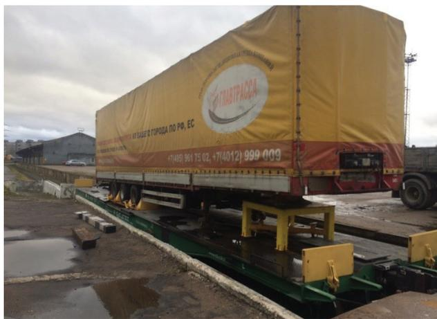
Рис. 2. Вагон-платформа модели 13–9938 с поворотным кругом для перевозки автоприцепов и контейнеров
